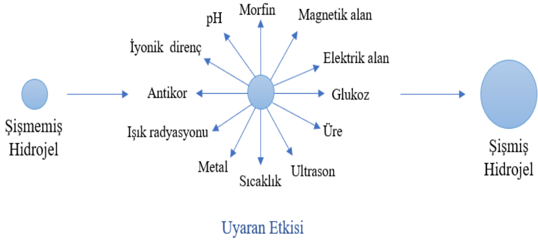
Şekil 2.9. Çevresel etkilere duyarlı hidrojelin şişme davranışı.
