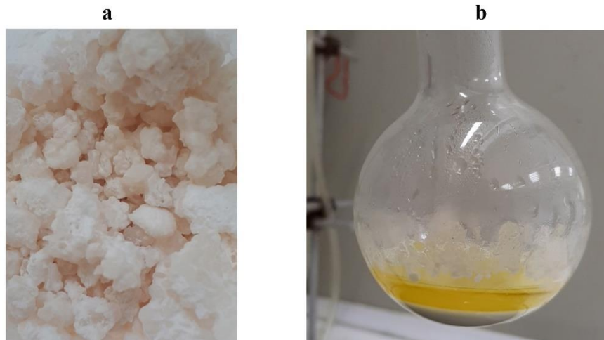
Şekil 3.2. a) Kurutulmuş ve kullanıma hazır monomer; b) monomerin sentez sonu hali.
