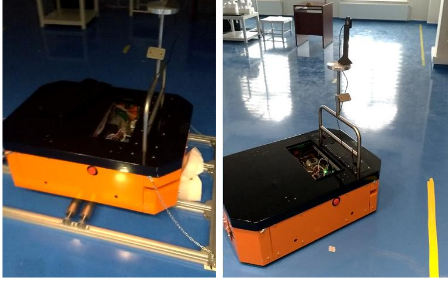
Şekil 3.5. AMR deney düzeneği ve laboratuvar test ortamı
