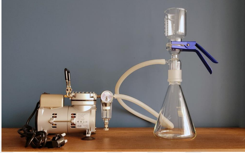
Şekil 6.5. AKM tayininde kullanılan deney düzeneği.
