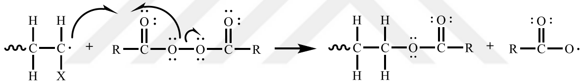
Şekil 4.12. Başlatıcıya transfer reaksiyon mekanizması.
