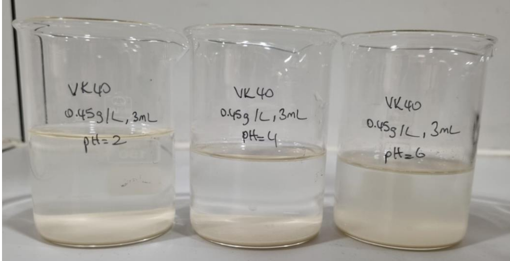
Şekil 7.11. PGMA-mod-DETA-mod-SA polimerinin flokülasyonuna pH etkisi.
