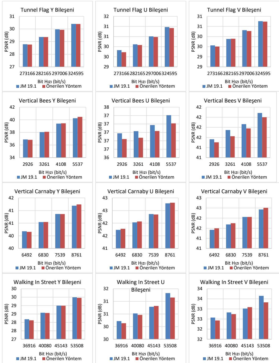
Şekil 5.12: Tunnel Flag, Vertical Bees, Vertical Carnaby ve Walking In Street video setleri için Y, U ve V bileşenlerinin önerilen yöntem ve JM 19.1 yazılımı ile kodlanmasının sonuçları
