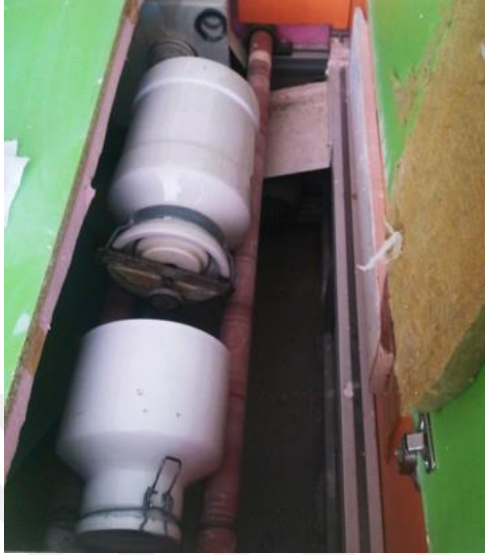
Şekil 5.2 Öğütme işlemlerinde kullanılan bilyalı değirmen
