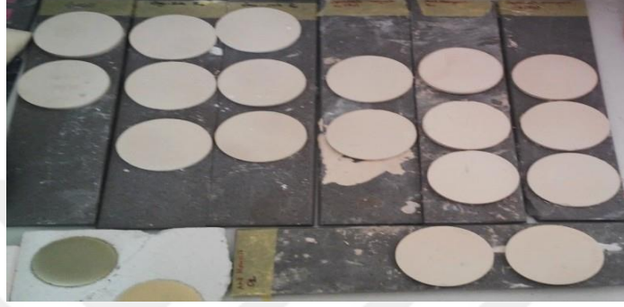
Şekil 5.3 Preslenerek şekillendirilen kordiyerit numuneleri
