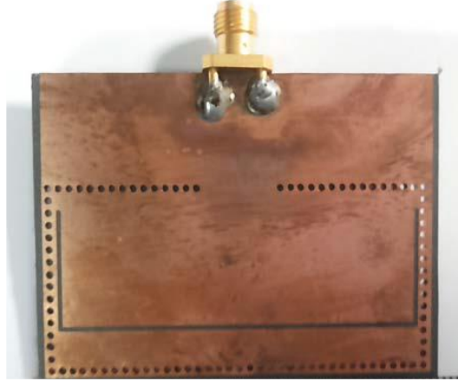
Şekil 2.23 U deseni slot anten (Astuti & Rahardjo, 2018)
