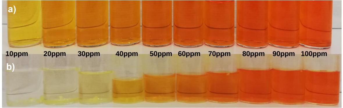
Şekil 4.19. Adsorpsiyon öncesi (a) ve adsorpsiyon sonrası (b) farklı derişimlerde hazırlanan MO çözeltileri.
