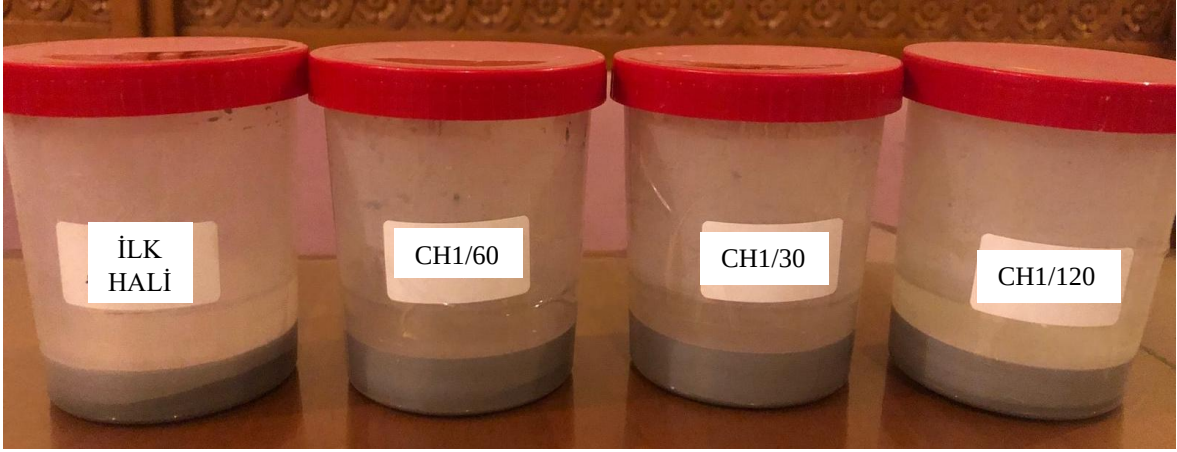
Şekil 5.16. %0,15 polimer çözeltisi ilaveli ADK boyalarının 24 saat sonunda meydana gelen çökme davranışları.
