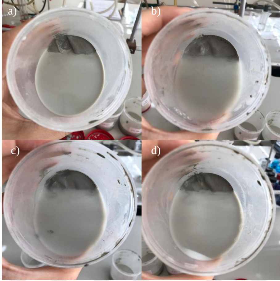
Şekil 5.18. %0,15 polimer çözeltisi ilaveli APS boyalarının 1 hafta sonunda meydana gelen çökme davranışları: a) polimer ilavesiz, b) CH1/60 ilaveli, c) CH1/30 ilaveli ve d) CH1/120 ilaveli.
