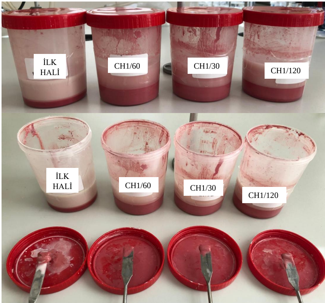
Şekil 5.14. %0,30 polimer çözeltisi ilaveli APS boyalarının 1 hafta sonunda meydana gelen çökme davranışları.
