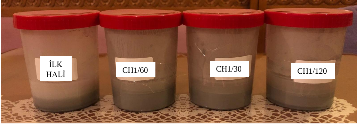
Şekil 5.19. %0,30 polimer çözeltisi ilaveli ADK boyalarının 24 saat sonunda meydana gelen çökme davranışları.
