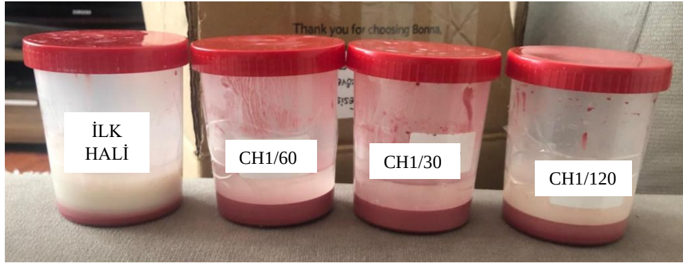
Şekil 5.10. %0,15 polimer çözeltisi ilaveli APS boyalarının 24 saat sonunda meydana gelen çökme davranışları.
