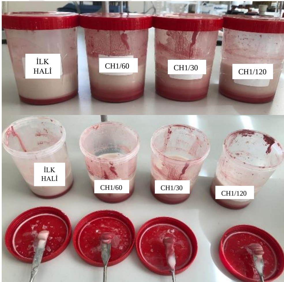
Şekil 5.8. %0,10 polimer çözeltisi ilaveli APS boyaların 24 saat sonunda meydana gelen çökme davranışları.
