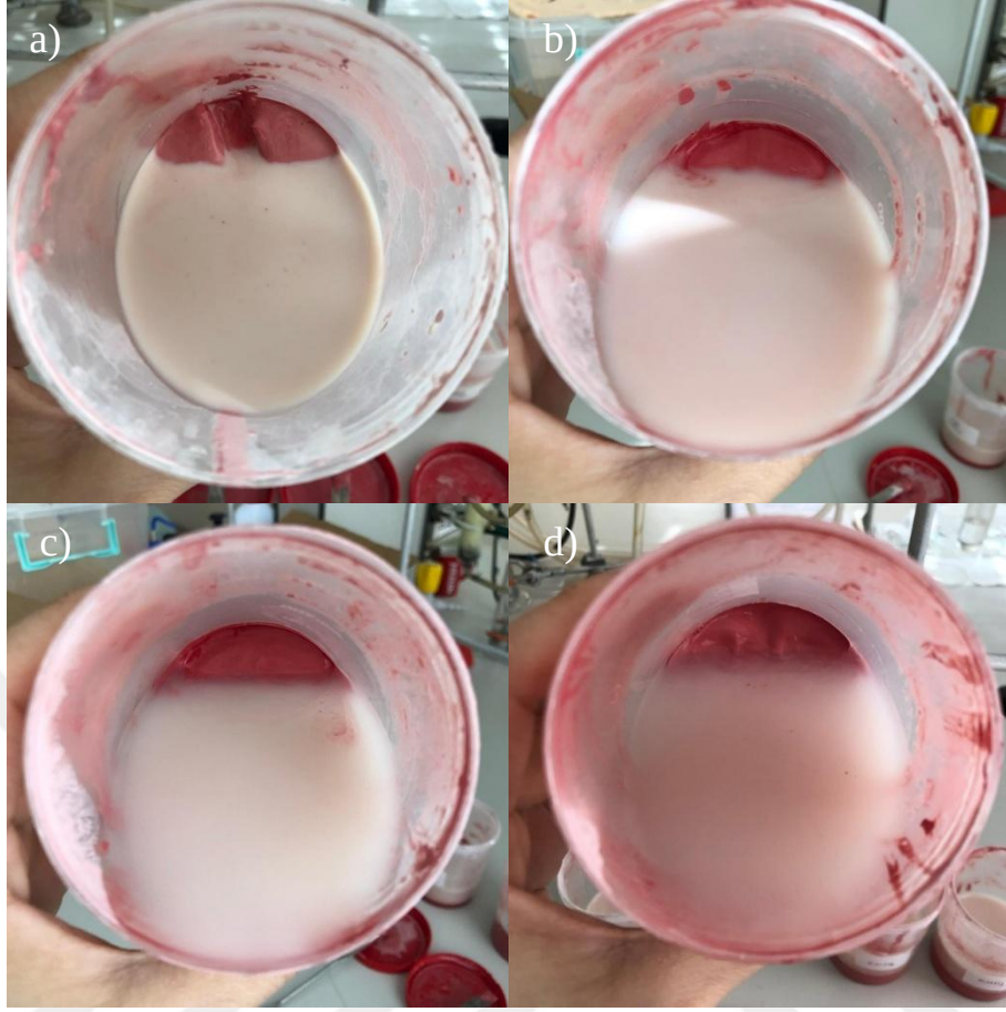
Şekil 5.15. %0,30 polimer çözeltisi ilaveli APS boyalarının 1 hafta sonunda meydana gelen çökme davranışları: a) polimer ilavesiz, b) CH1/60 ilaveli, c) CH1/30 ilaveli ve d) CH1/120 ilaveli.
