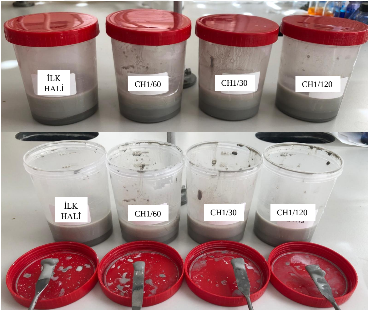
Şekil 5.17. %0,15 polimer çözeltisi ilaveli ADK boyalarının 1 hafta sonunda meydana gelen çökme davranışları.
