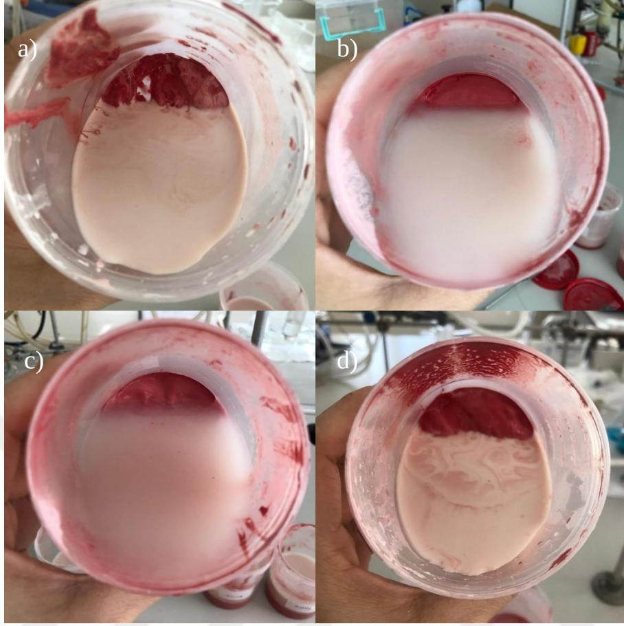
Şekil 5.12. %0,15 polimer çözeltisi ilaveli APS boyalarının 1 hafta sonunda meydana gelen çökme davranışları: a) polimer ilavesiz, b) CH1/60 ilaveli, c) CH1/30 ilaveli ve d) CH1/120 ilaveli.
