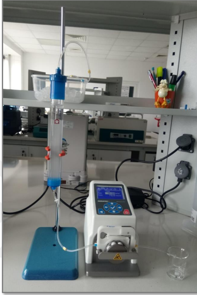
Şekil 3.9. DEAE-Sephadex A-50 iyon değişim kolonu
