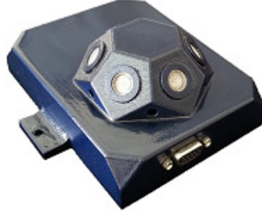
Şekil 4.12 Gesgin Algılayıcı Birim (GAB) üzerindeki alıcılar
