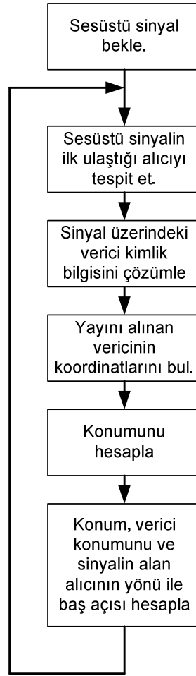
Şekil 4.13 GAB ile baş açısı hesaplama akış şeması
