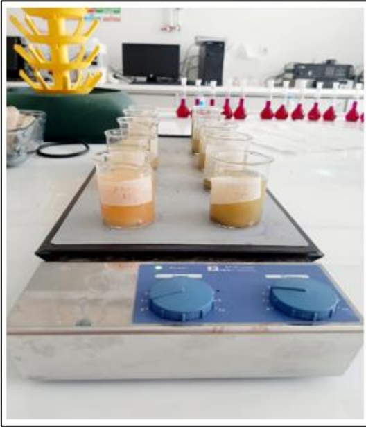
Şekil 6.8. Isıticılı çoklu karıştırıcıda gerçekleştirilen Cr 6+ adsorpsiyon denegi ve Cr 6+ tayini
