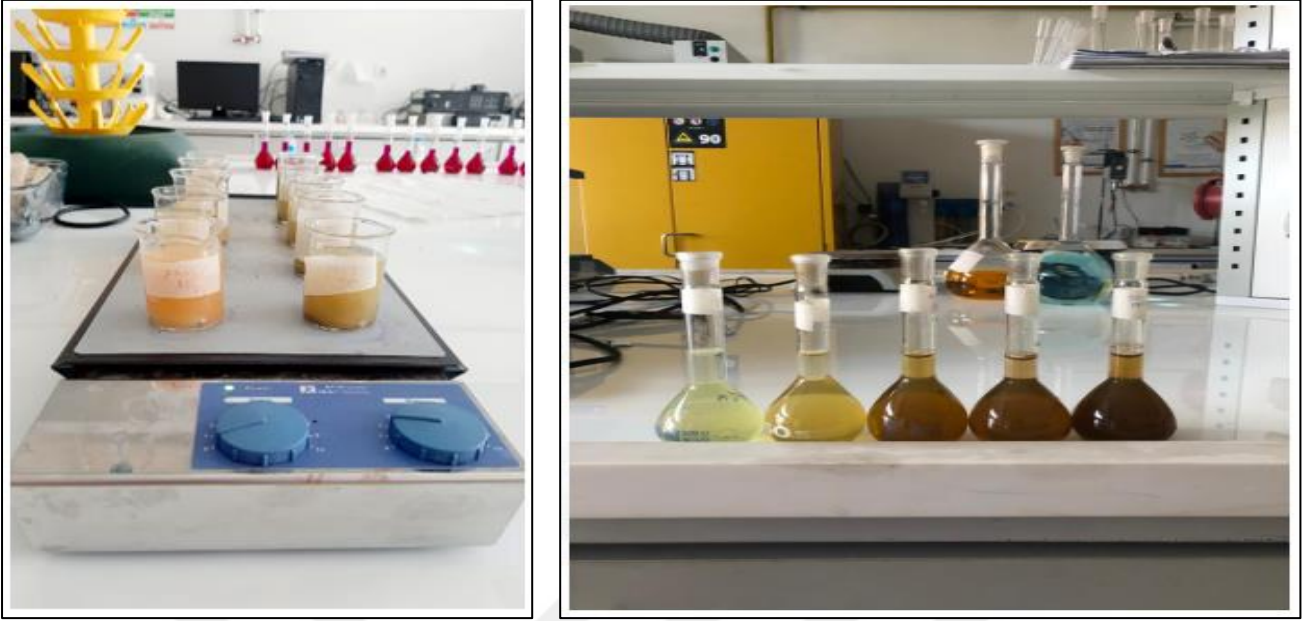
Şekil 6.9. Isıticılı çoklu karıştırıcıda gerçekleştirilen \text{Cu}^{2+} adsorpsiyon deneği ve \text{Cu}^{2+} tayini
