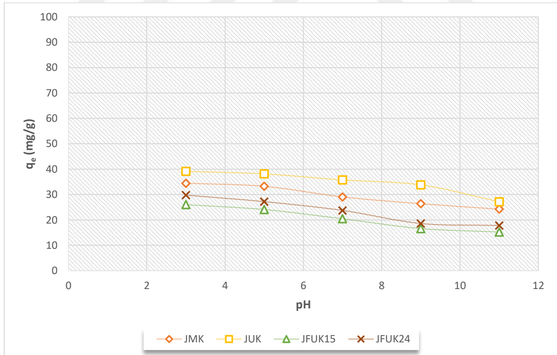
Şekil 7.2. JMK, JUK, JFUK15 ve JFUK24 jeopolimerleri ile \text{Cr}^{6+} adsorpsiyon kapasitesine pH'ın etkisi ( C_0 = 100\text{mg/L} , T=25^\circ\text{C} , t=24 st, 150 rpm karıştırma hızı)
