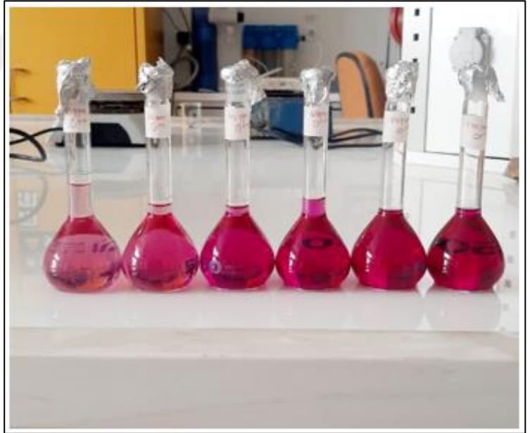
Şekil 6.8. Isıticılı çoklu karıştırıcıda gerçekleştirilen Cr 6+ adsorpsiyon denegi ve Cr 6+ tayini
