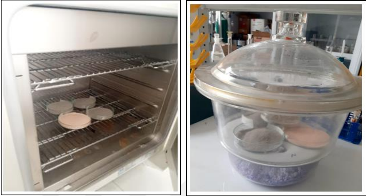
Şekil 6.4. Jeopolimerlerin fırında kurutulması ve desikatörde muhafaza edilmesi
