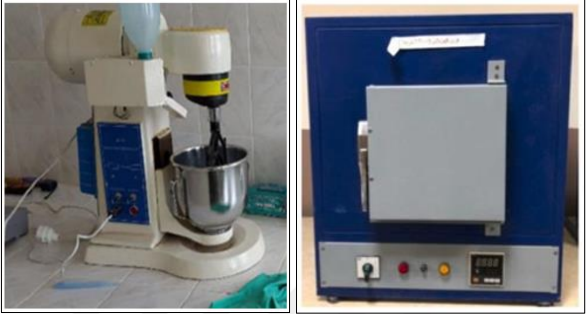
Şekil 6.2. Mekanik karıştırıcı ve kütleme işleminin yapıldığı fırın
